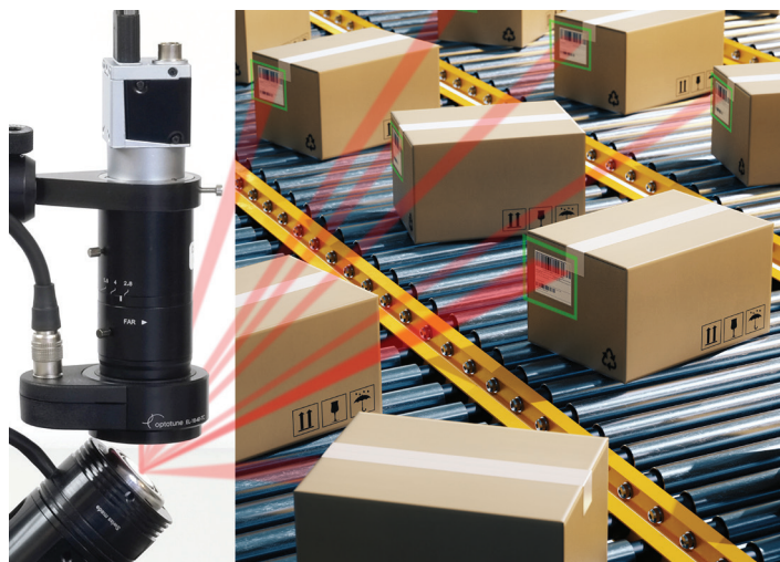
光束控制振镜与液态镜片结合，可用于视野拓展与AOI选择等应用
